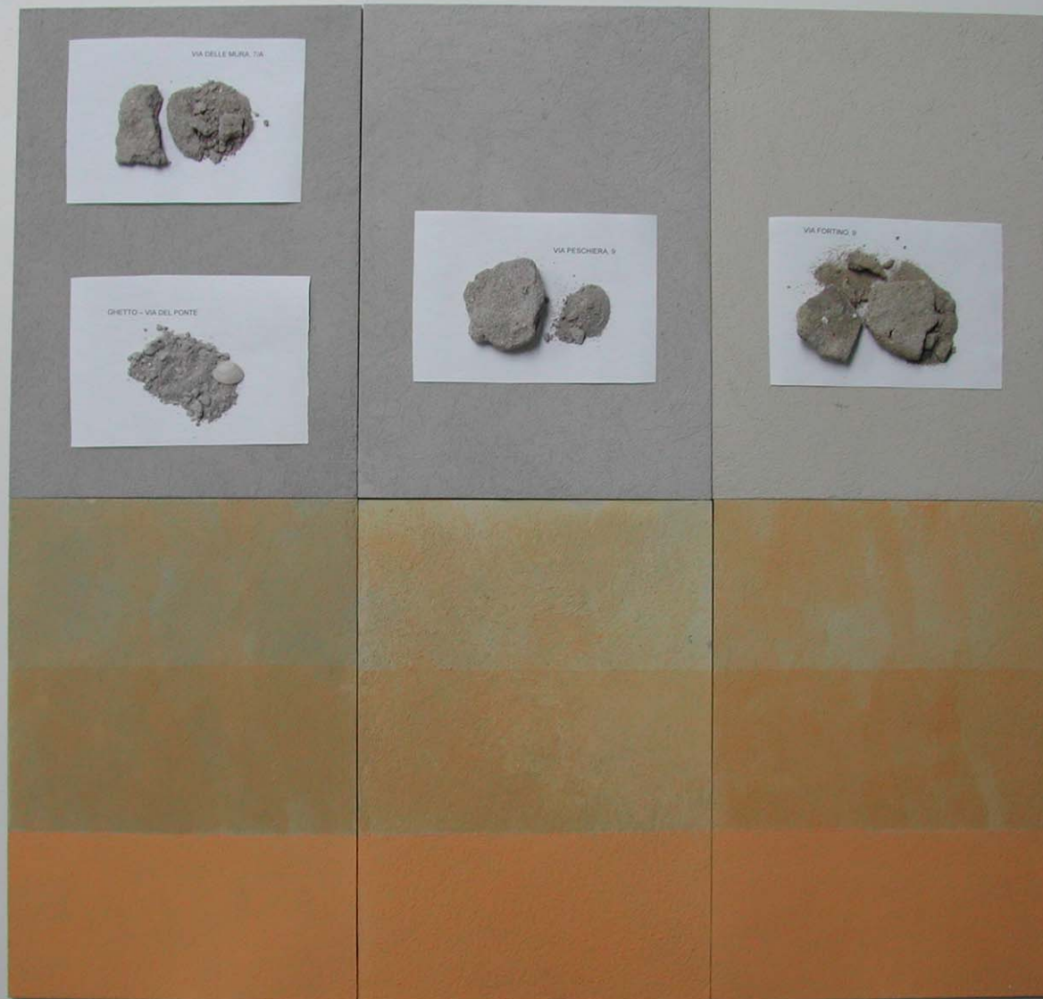
Tavolette-campione con sottofondo e tinta in più strati
